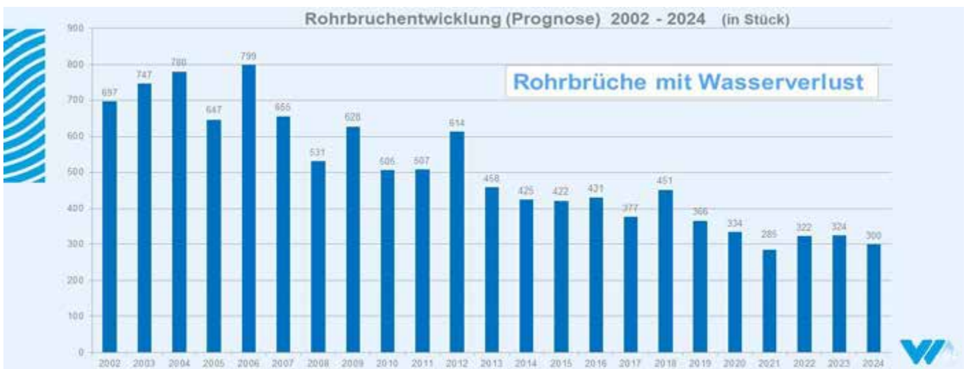
Bild: Die Wasserrohrbrüche konnten seit 2002 signifikant reduziert werden. Quelle: Wasserwerke Zwickau GmbH
